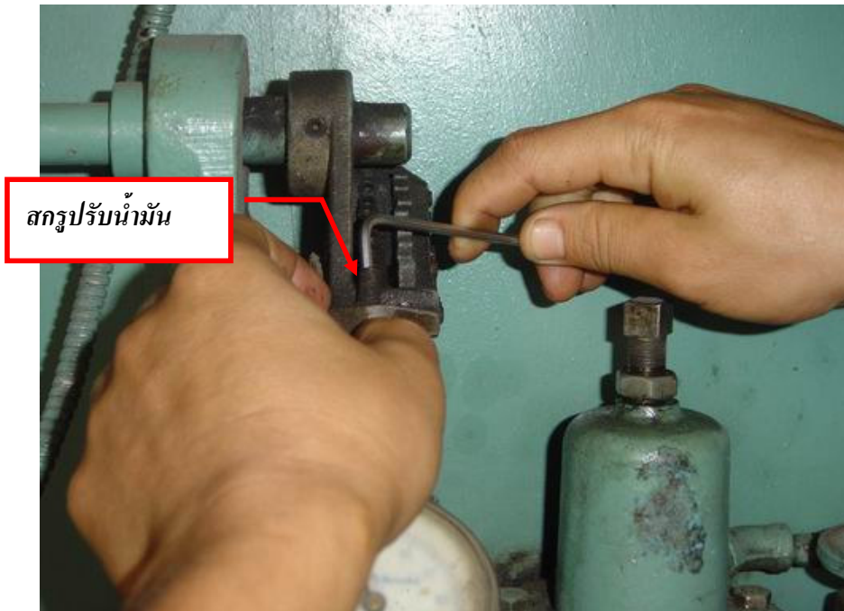
รูปที่ 4.25 แสดงการปรับปริมาณน้ำมัน
