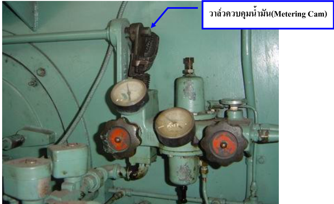
รูปที่ 4.22 แสดงลักษณะชุดลูกเบี้ยวควบคุมน้ำมัน(Metering Cam)
