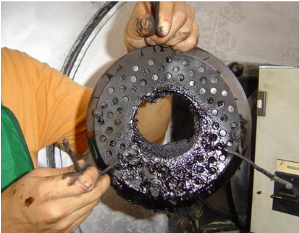
รูปที่ 4.4 การตั้งระยะกระจิงลมห่างจากหัวฉีดมาก ทำให้ฉีดน้ำมันชนกระจิงลม
