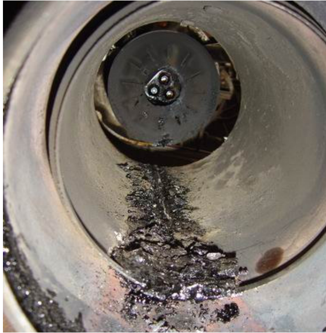
รูปที่ 4.3 การบำรุงรักษาใช้สวดแข็งแรงแรงหัวฉีดทำให้การฉีดน้ำมันไม่เป็นฝอย
