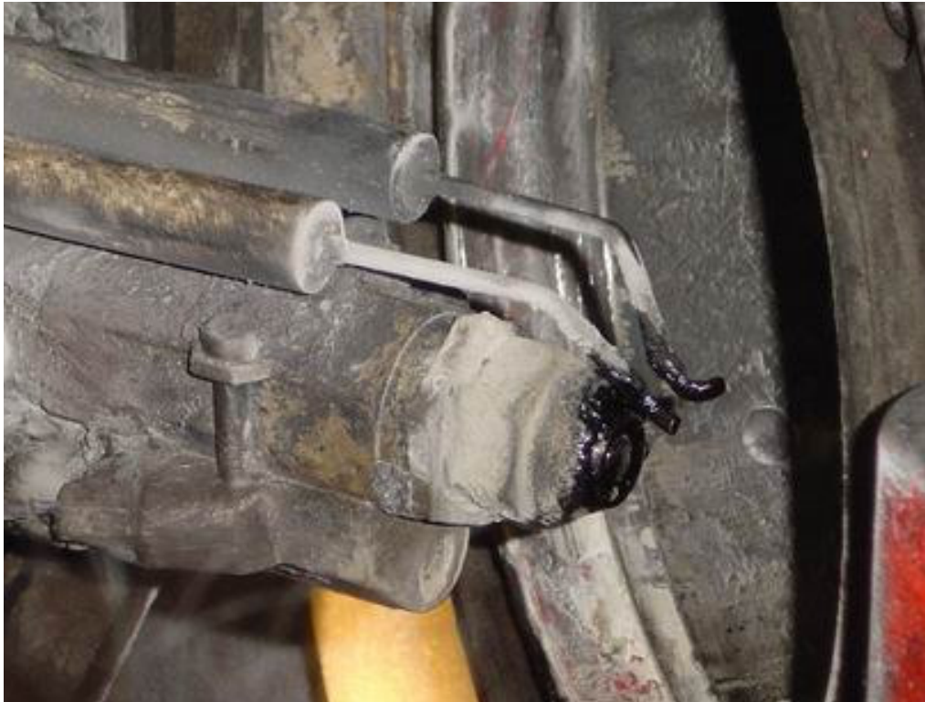
รูปที่ 4.5 การตั้งระยะเข็มสปาร์ตห่างจากหัวฉีดมาก ทำให้ฉีดน้ำมันชนเข็ม
