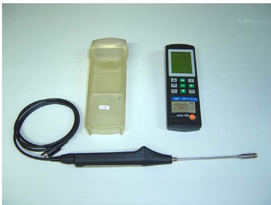
รูปที่ 3.6 เครื่องมือวัดอุณหภูมิแบบสัมผัส
