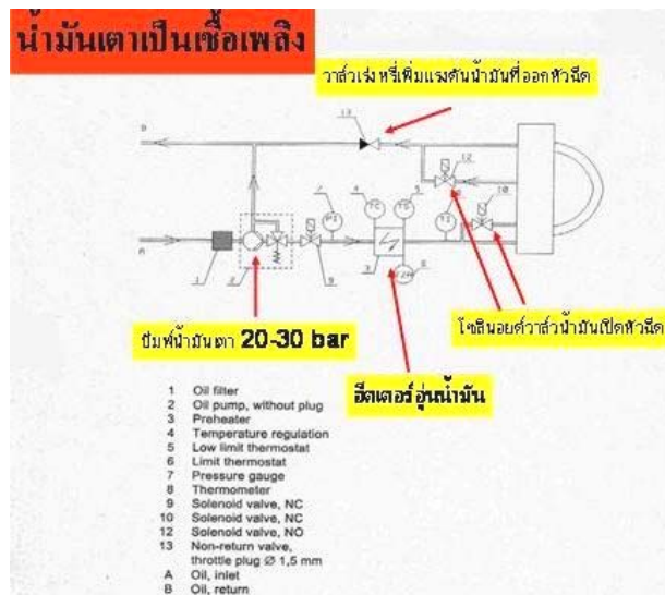
รูปที่ 5.5 วงจรน้ำมันของหัวพ่นน้ำมัน แบบ modulating
