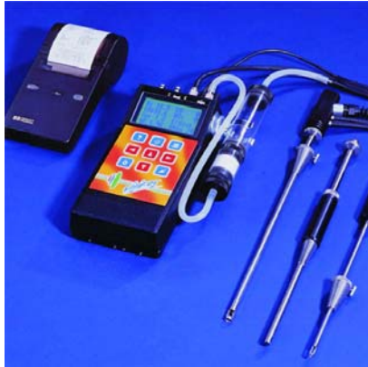
รูปที่ 5.1 เครื่องมือวิเคราะห์แก๊สไอเสีย
